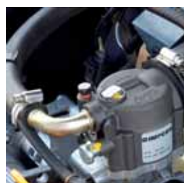
Miscelatore adattato per gas metano
